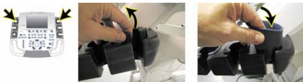
Рис. 2-9. Установка дополнительной емкости для геля
