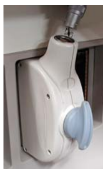
Рис. 1-16. Совместите разъем адаптера с портом датчика (левый рисунок). Вставьте разъем датчика в адаптер (правый рисунок).
