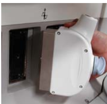
Рис. 1-16. Совместите разъем адаптера с портом датчика (левый рисунок). Вставьте разъем датчика в адаптер (правый рисунок).
