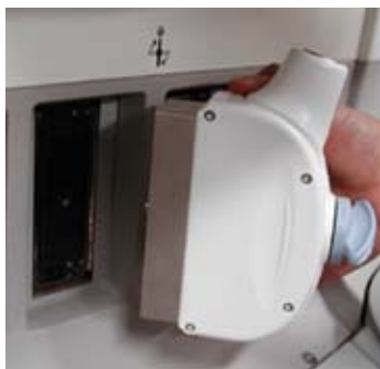
Рис. 1-20. Совместите разъем адаптера с портом датчика (левый рисунок). Вставьте разъем датчика в адаптер (правый рисунок).
