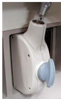
Рис. 1-20. Совместите разъем адаптера с портом датчика (левый рисунок). Вставьте разъем датчика в адаптер (правый рисунок).
