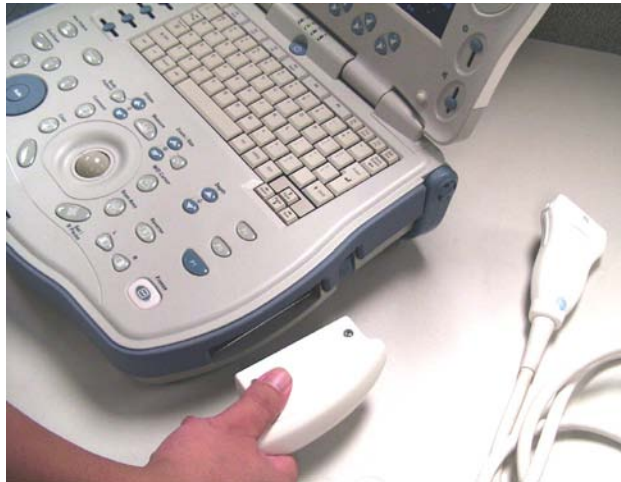
Рис. 1-12. Подсоединение датчика к LOGIQ Book XP/XP PRO
