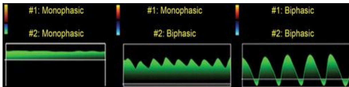
Рисунок 6 Неоднозначность интерпретации фаз. Схемы иллюстрируют, как различные интерпретации того, что составляет фазу, могут влиять на характеристики и номенклатуру сигналов. DAM интерпретирует фазу как компонент формы волны по обе стороны от базовой линии; ММАУ интерпретирует фазу как перегиб.
