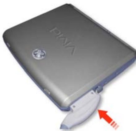
Рис. 2-13: Подсоединение датчика к Vivid i / Vivid q
