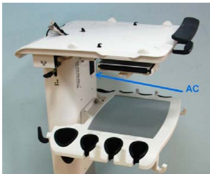
Рис. 3-7: Изолированные розетки питания переменного тока для периферийных устройств
