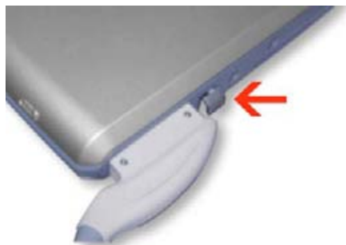
Рис. 2-14: Рычаг фиксации разъема датчика
