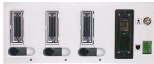
Vivid S6: 3 гнезда типа RS и одно типа OR для чреспищеводных датчиков
