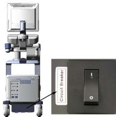
Рис. 1-20. Местоположение автоматического выключателя
