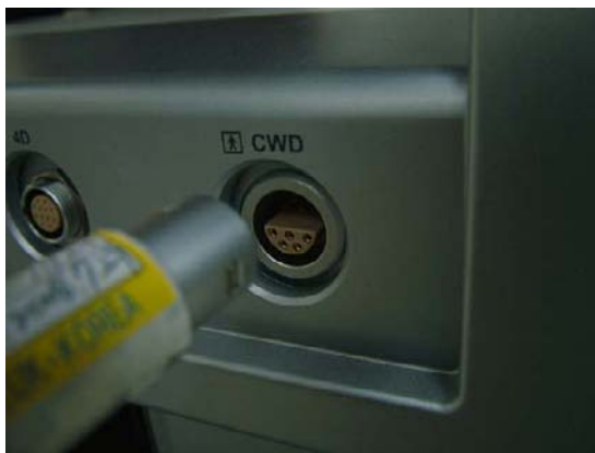
Рис. 1-21. Совместите разъем с портом датчика перед тем как вставлять его в порт
