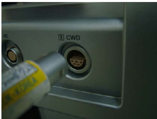
Рис. 1-20. Совместите разъем с портом датчика перед тем как вставлять его в порт
