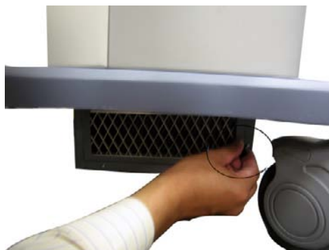
Рис. 3-9. Открутите боковой воздушный фильтр
