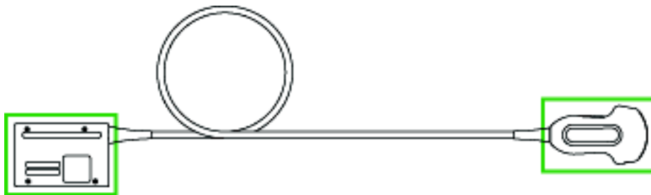
Рис. 11-1 Части датчиков, которые можно протирать спиртом
