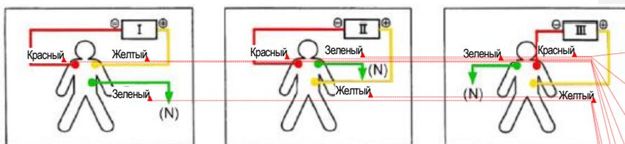
2. Эта система рассчитана на использование провода I. Чтобы использовать провод II или провод III, цвета проводов и места соединений отличаются от стандартной схемы.
