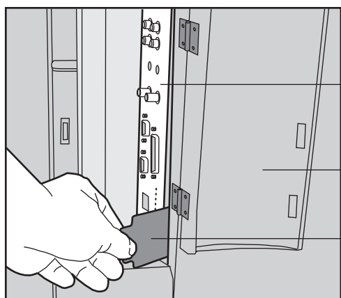
Извлечение воздушного фильтра из панели ввода/вывода.
